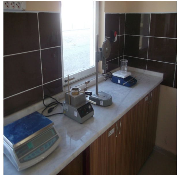
- Hassas Terazi – Parlama Noktası - Deney Seti - Yumuşama Noktası Deney Seti - Penetrasyon Deney Seti
